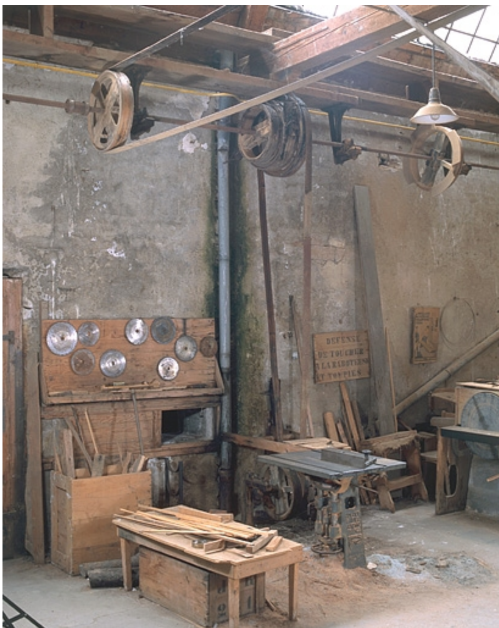
Vue d'ensemble avec le système de transmission.
