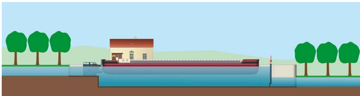
Schéma d'éclusage d'un bateau avalant, étape 4.
