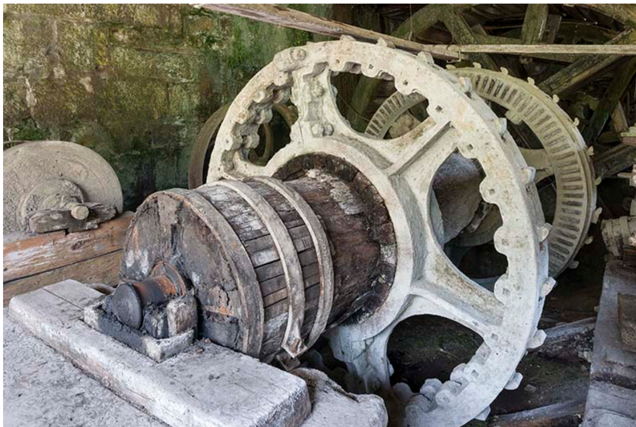
Arbre de couche de la roue hydraulique. Au second plan, roue dentée actionnant un polissoir.
