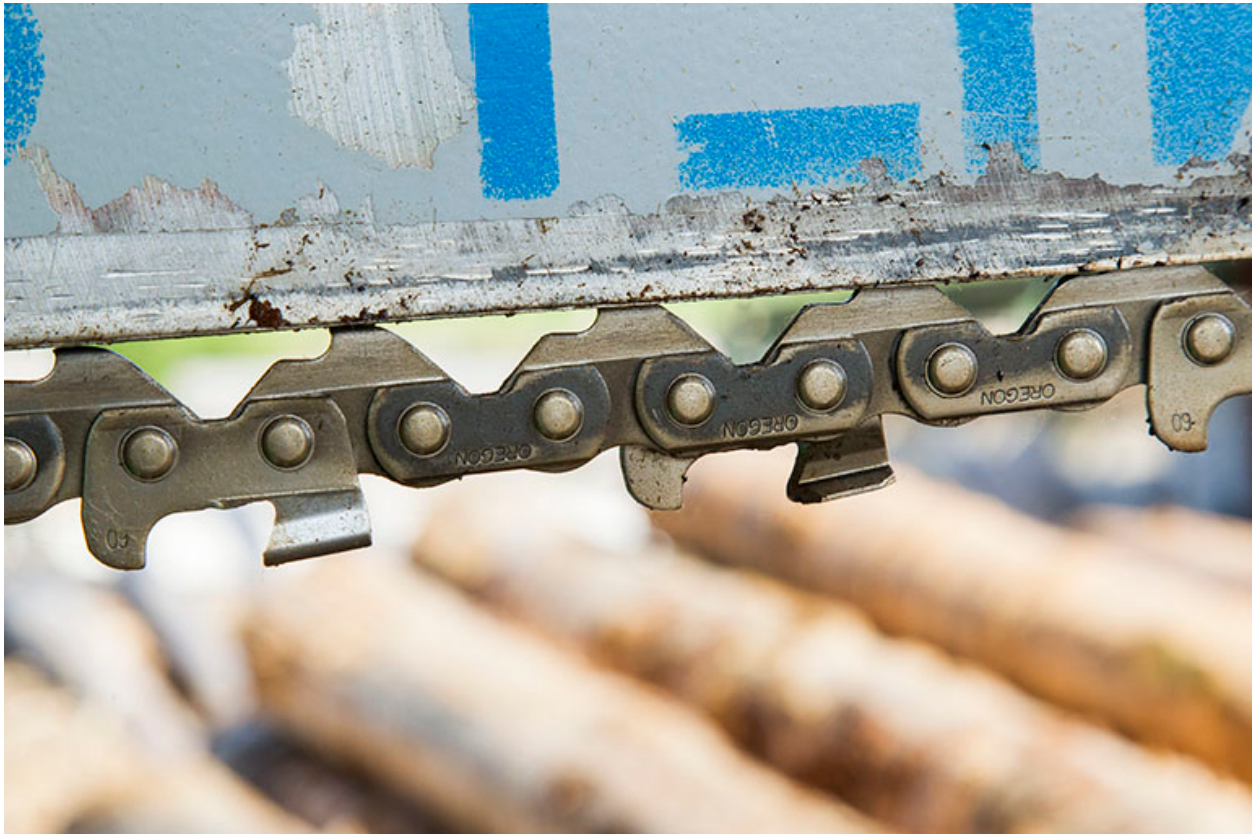
Parc aux grumes : bras de sciage de la scie Herkules (détail de la chaîne).
