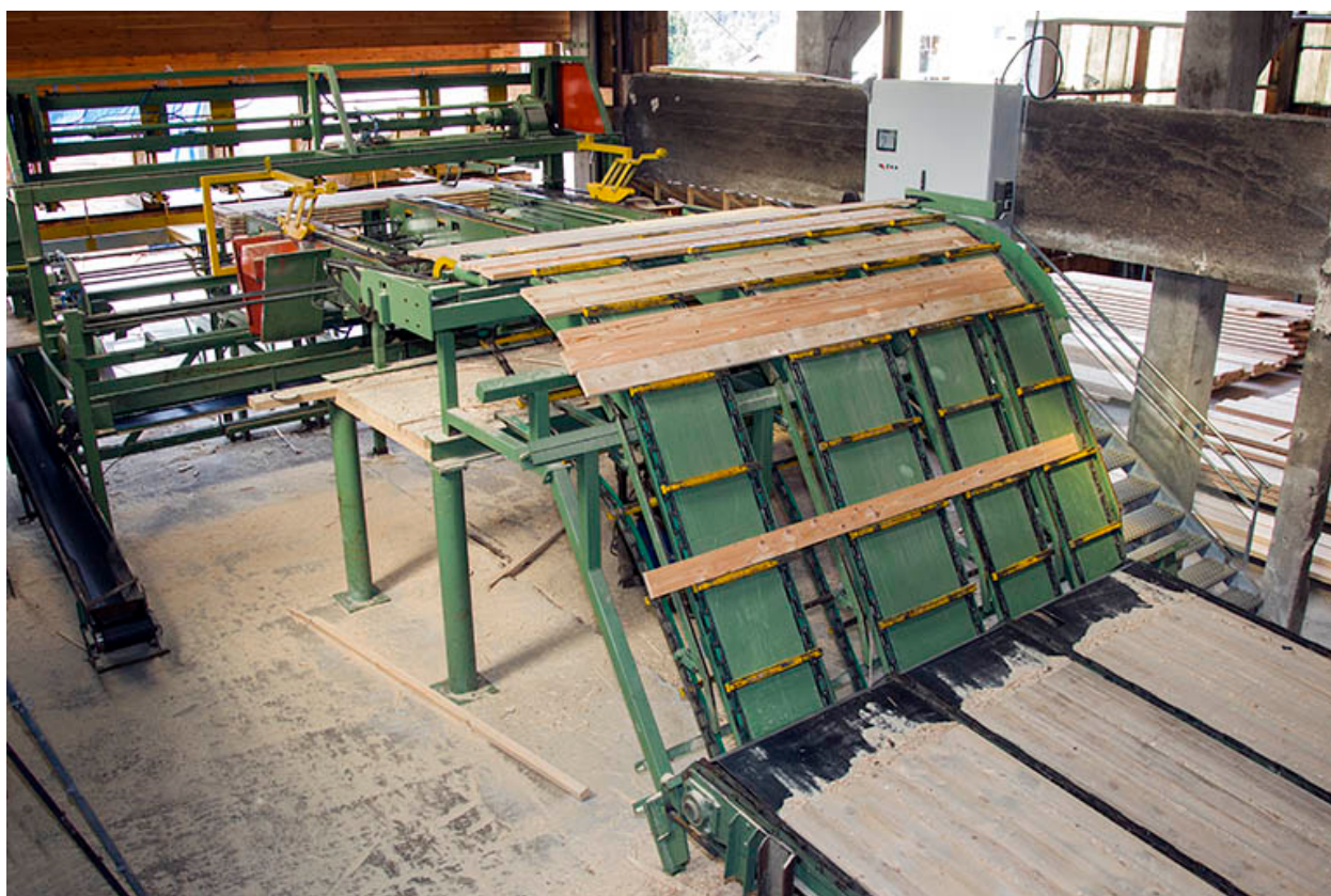
Atelier de triage et d'empilage (F) : empileuse.
