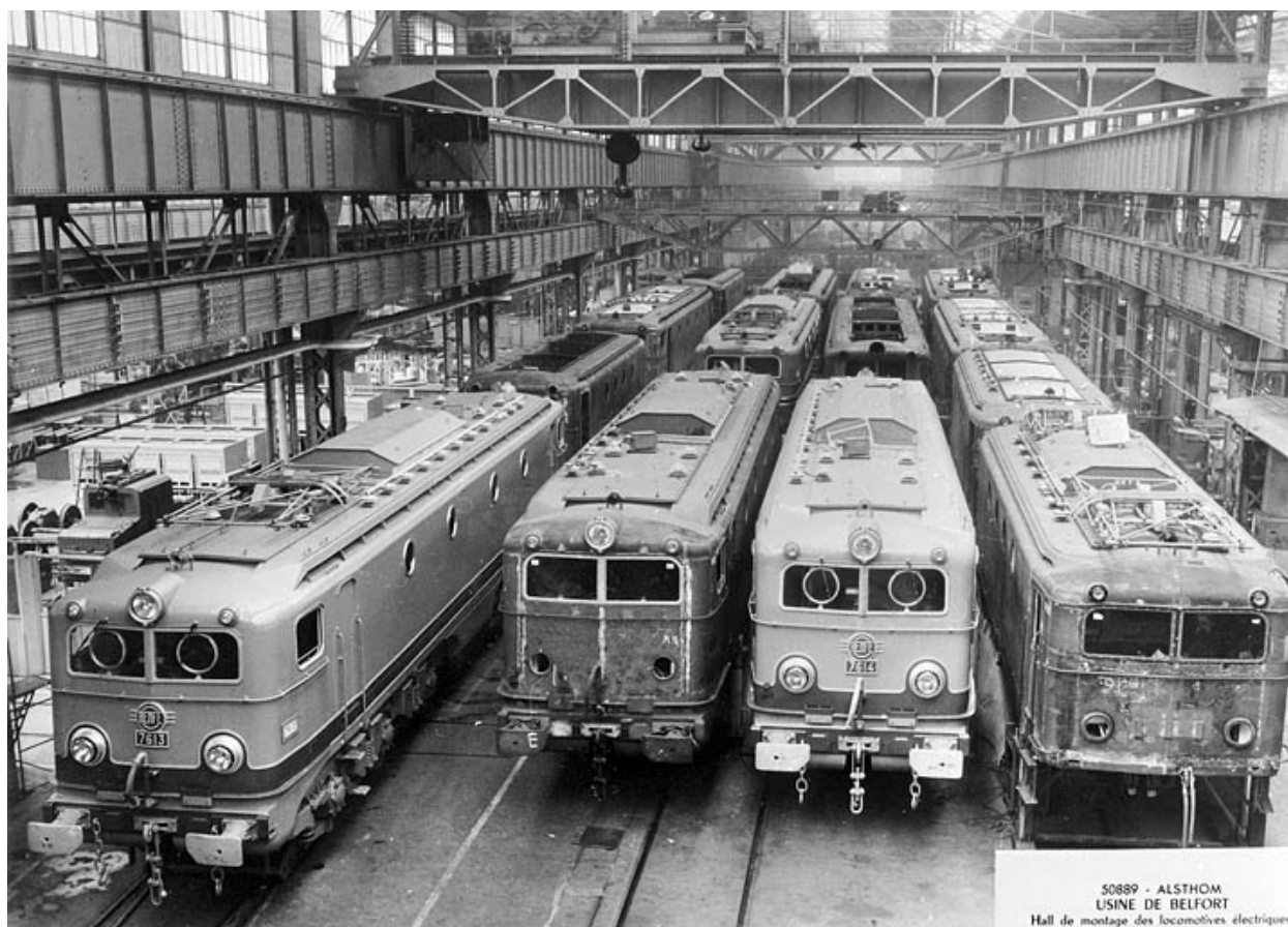
Hall de montage des locomotives électriques.
