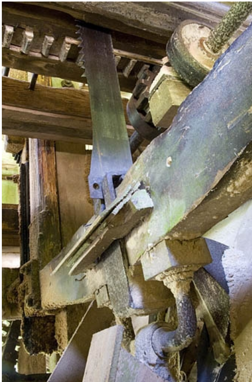
Etage de soubassement. Détail de la transmission : manivelle et lame de la scie vues du dessous.
