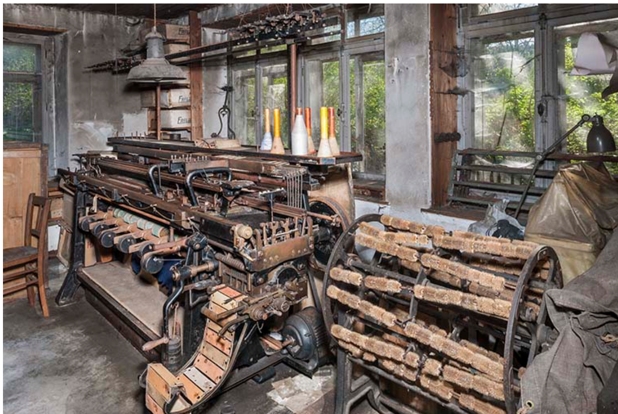
Machine à tricoter à plat (métier à mailles retournées Stoll & C°, à gauche) et machine à carder rotative (à droite).
