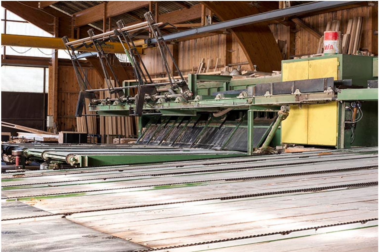
Atelier de fabrication (2000) : déligneuse Remonnay (Villers-le-Lac).
