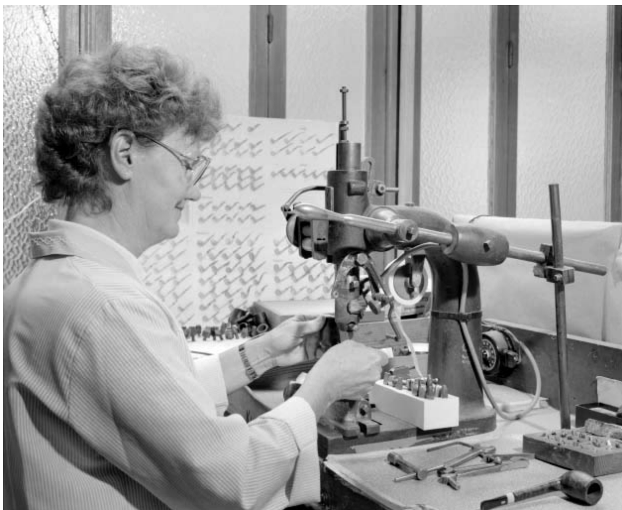
Marquage d'une pipe.
