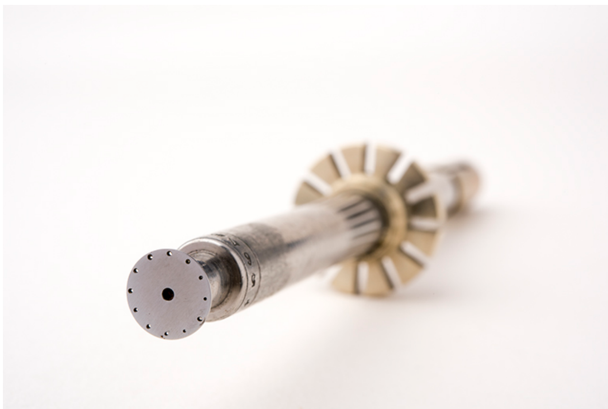
Grande broche : extrémité avec la lanterne.
