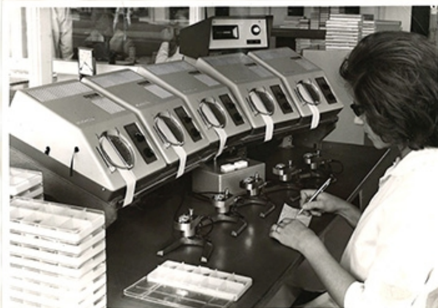
APPAREIL POUR COMPTAGE AUTOMATIQUE DES SPIRAUX + + + + +
