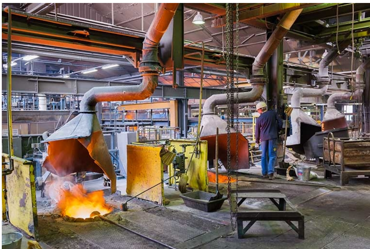
Partie supérieure des fours à induction.
