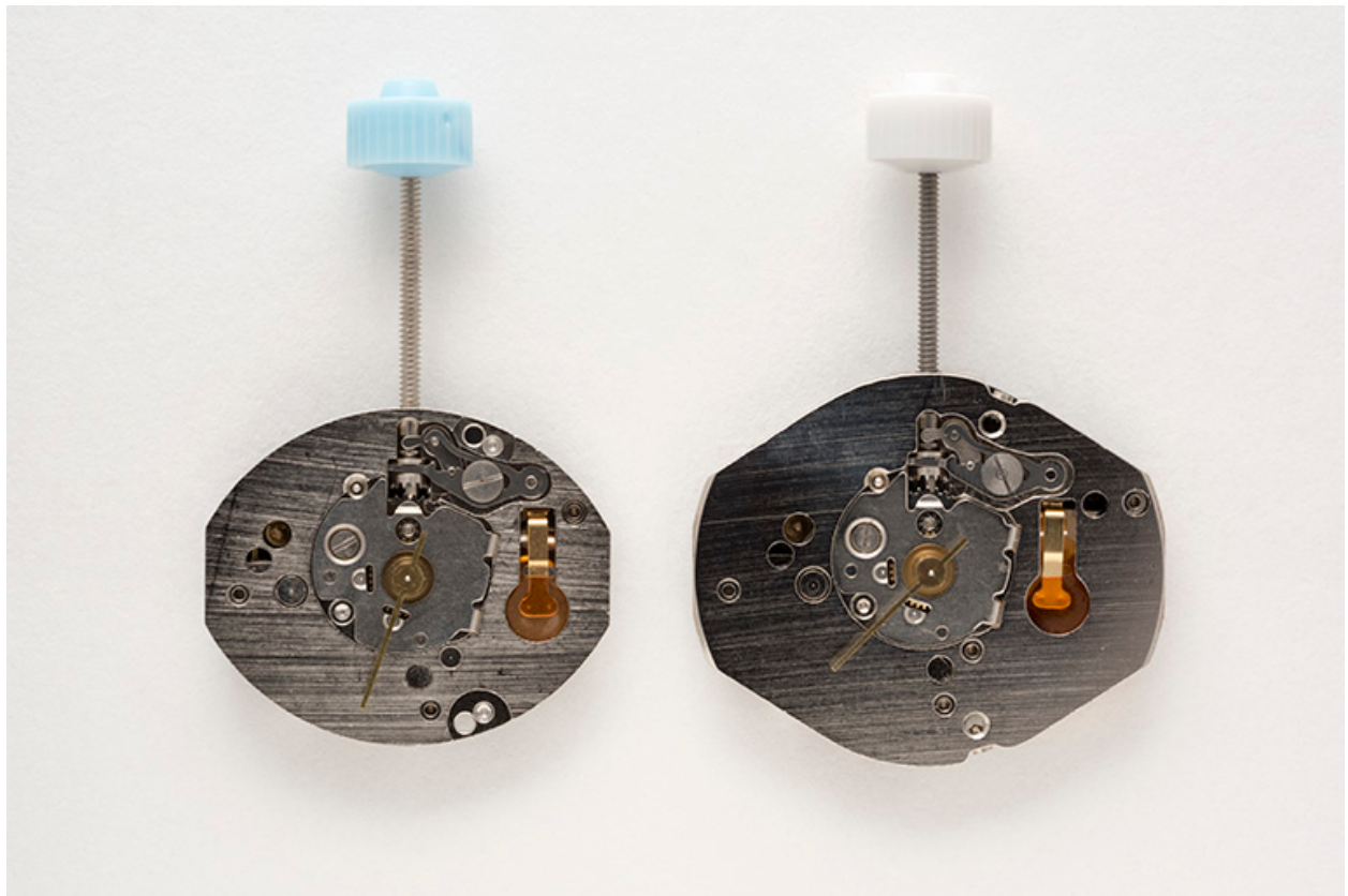
Deux mouvements de montre à quartz France Ebauches FE 5120 (à gauche) et 6120 (à droite).
