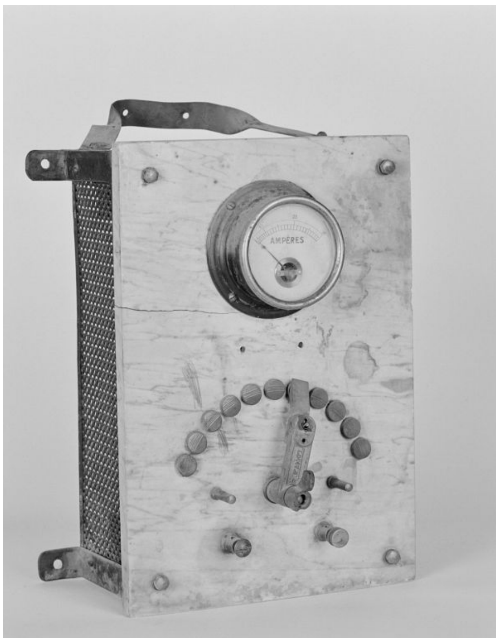
Accessoire d'éclairage, 1988 : rhéostat (transformateur).
