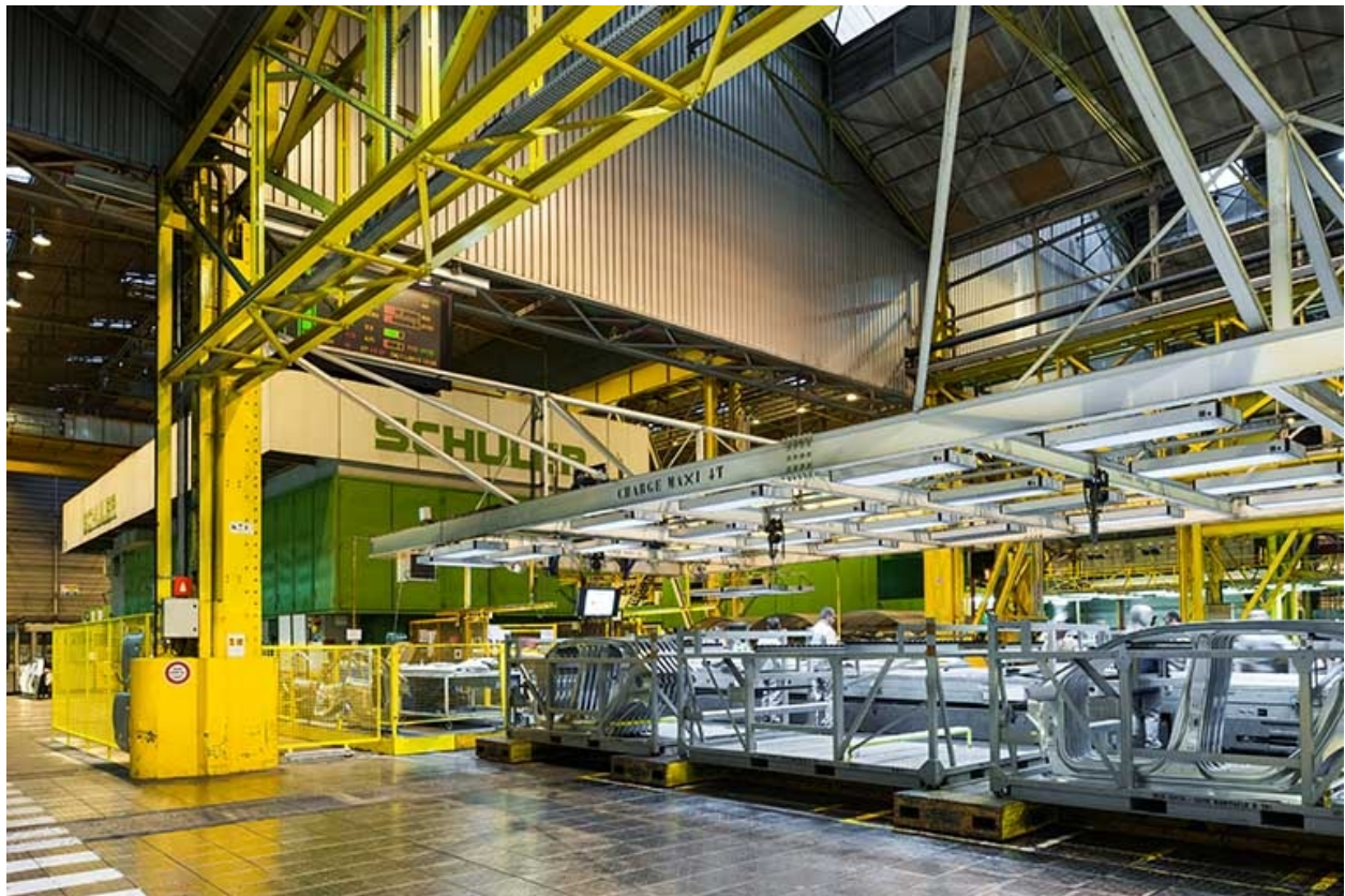
Automobile : usine Peugeot à Sochaux, atelier d'emboutissage, presse Schuler.
