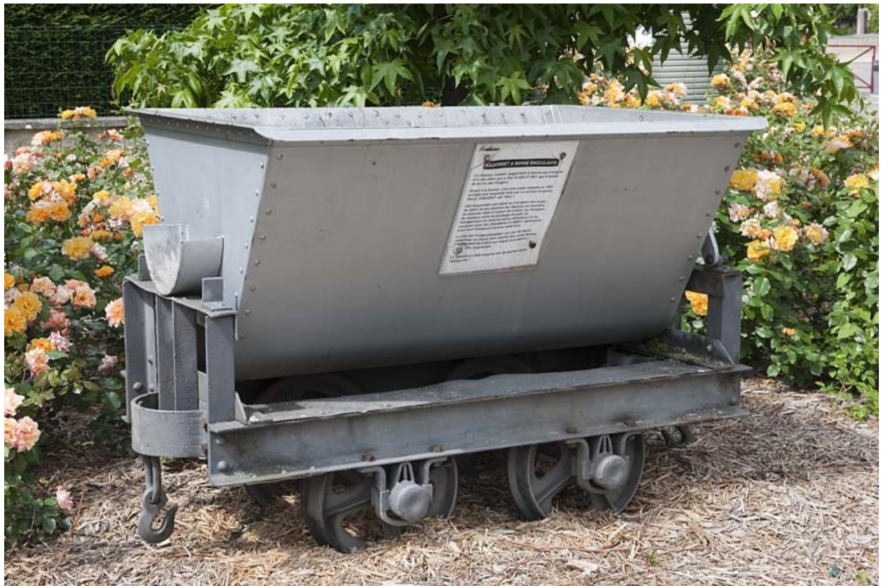
Wagonnet servant au transport du laitier vers le crassier, tiré par des locomotives "Decauville" (seul le châssis est d'origine).
