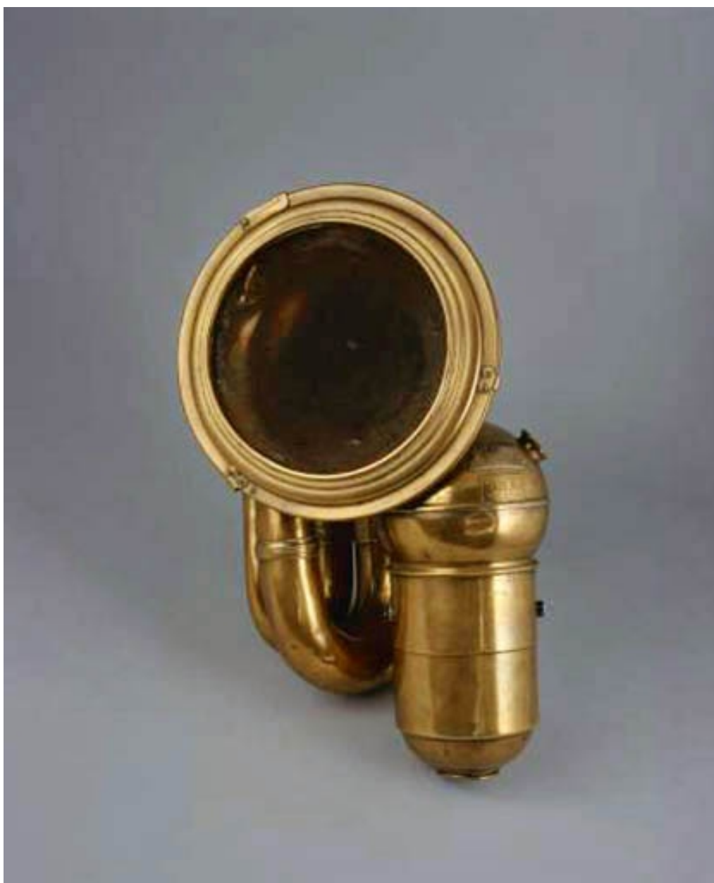
Avertisseur sonore pneumatique pour automobile.
