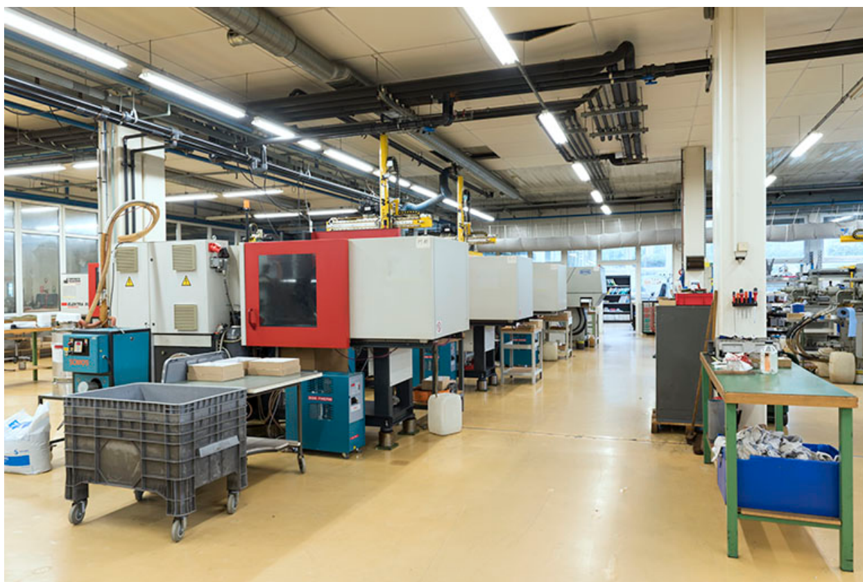
Atelier d'injection : les nouvelles presses.
