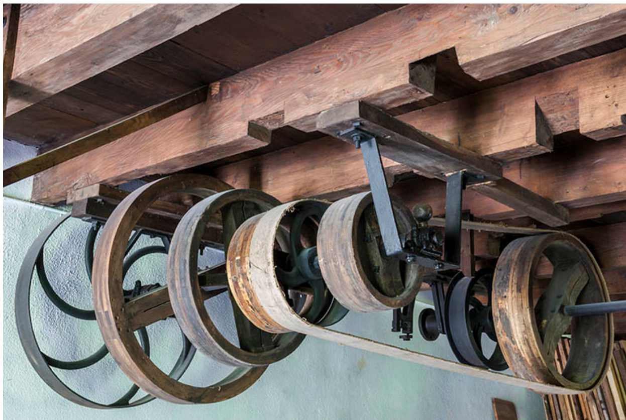
Détail de la transmission par poulies.
