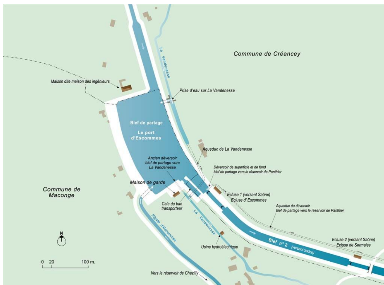
Plan schématique du port d'Escommes et du bief 02 du versant Saône.
