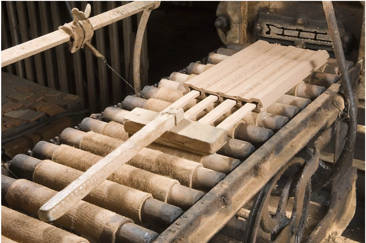
Tuilerie et briqueterie Janicot, Montureux-et-Prantigny. Chariot de découpe de la mouleuse-étireuse Brandt : enlèvement d'une brique creuse (la filière est visible en haut à droite).
