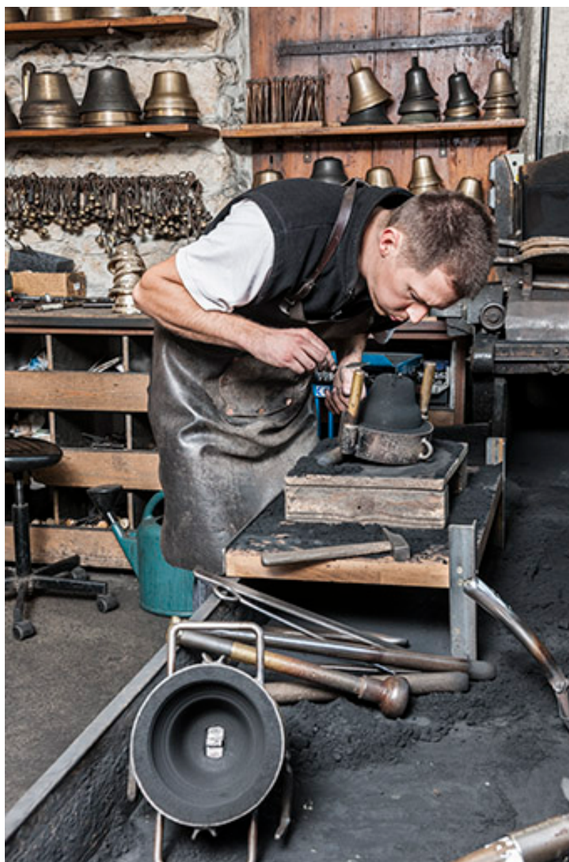
Moulage. Travail de finition à la spatule.
