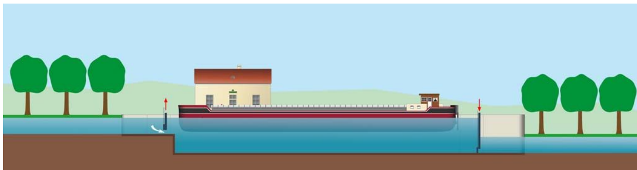
Schéma d'éclusage d'un bateau montant, étape 7.
