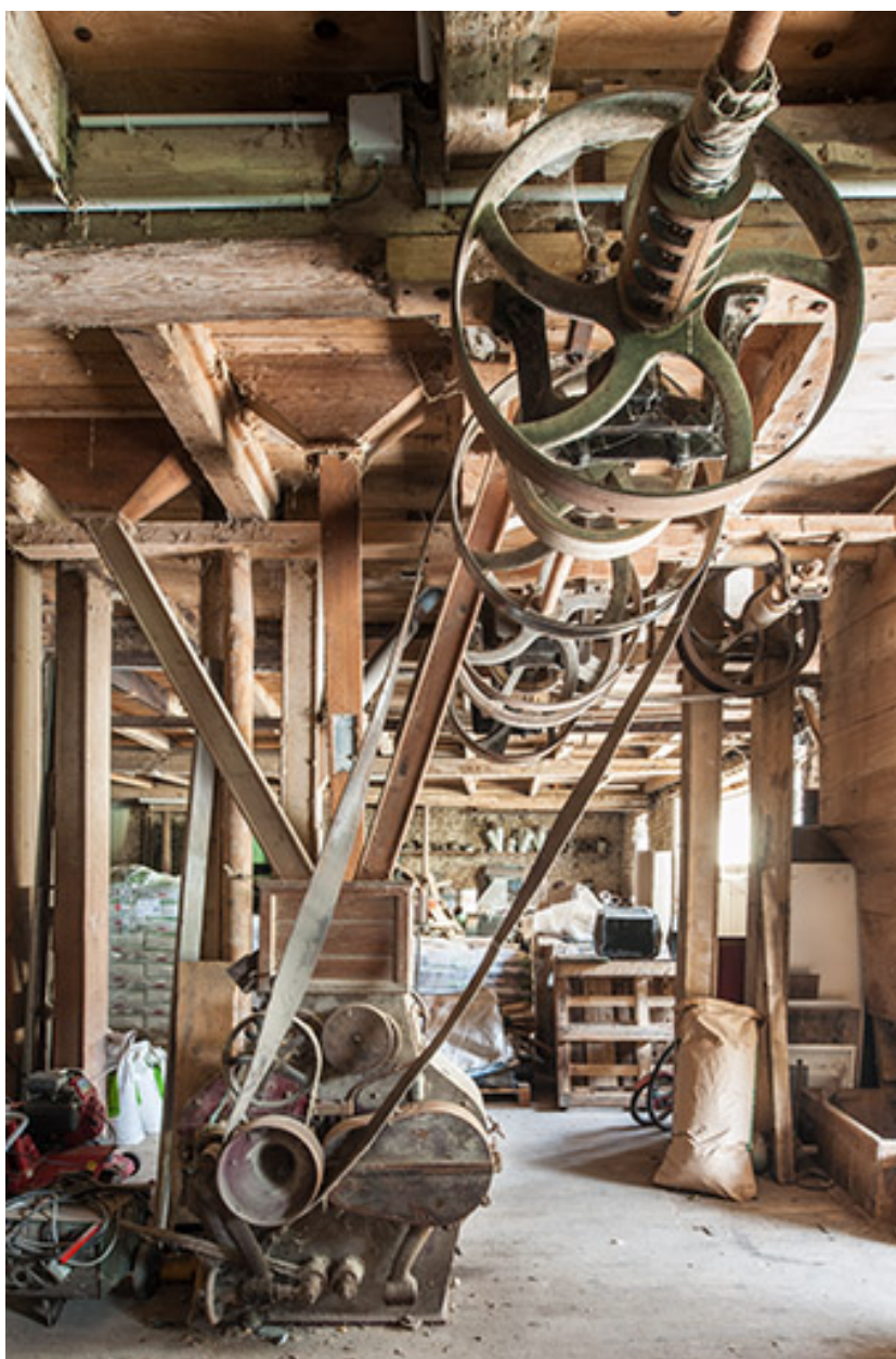
Rez-de-chaussée surélevé. Broyeur à cylindres Lacroix et le système de transmission.
