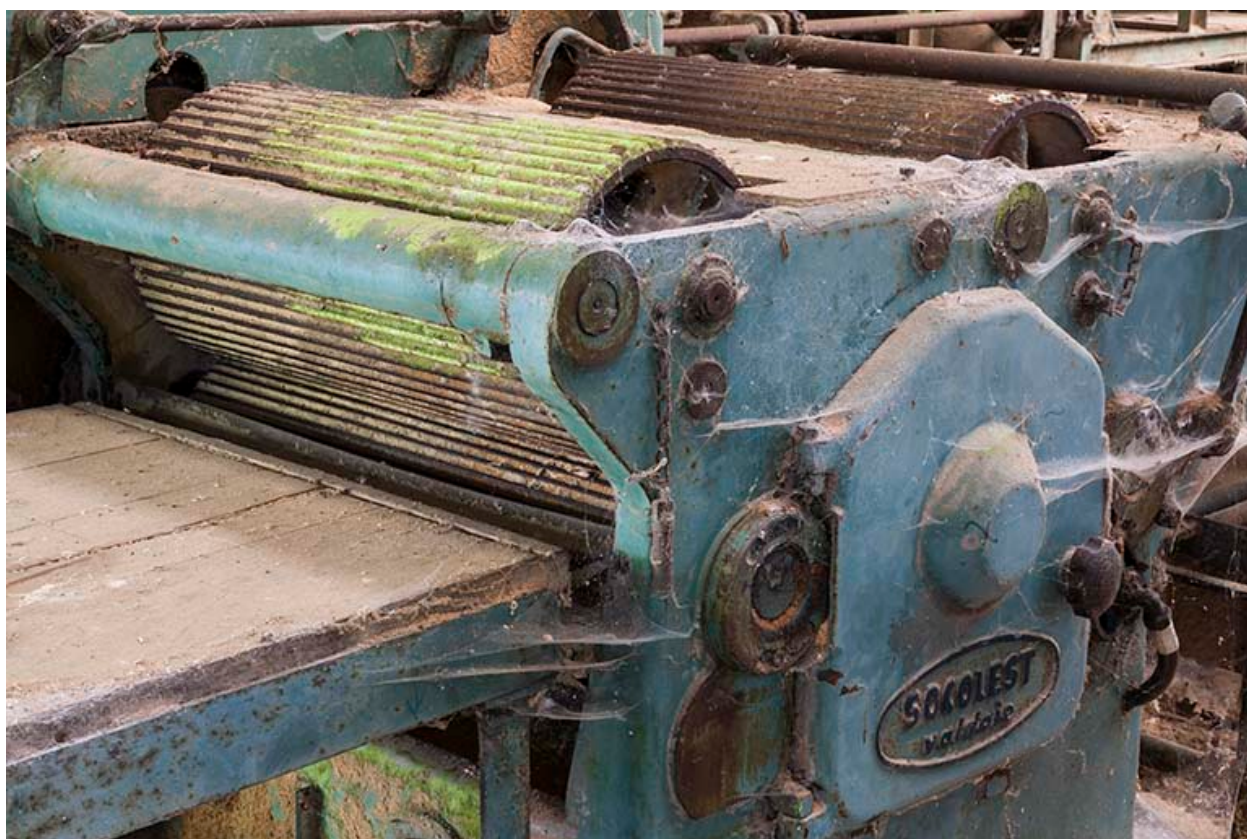
Déligneuse. Détail des rouleaux cannelés.
