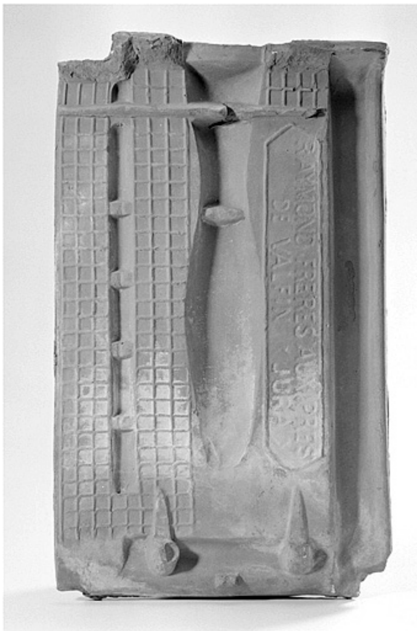
Vue de dessous d'une tuile dite « à la truite ».
