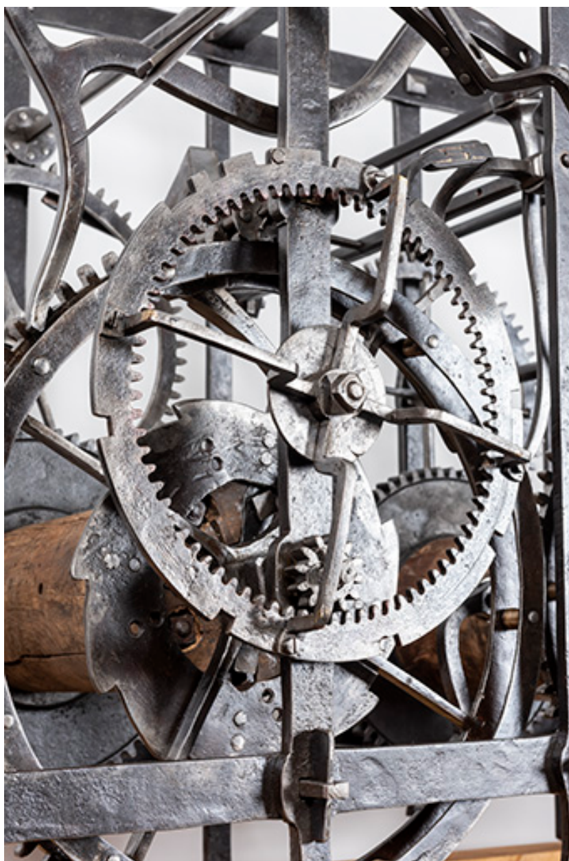
Détail de l'horloge publique : la roue de compte.
