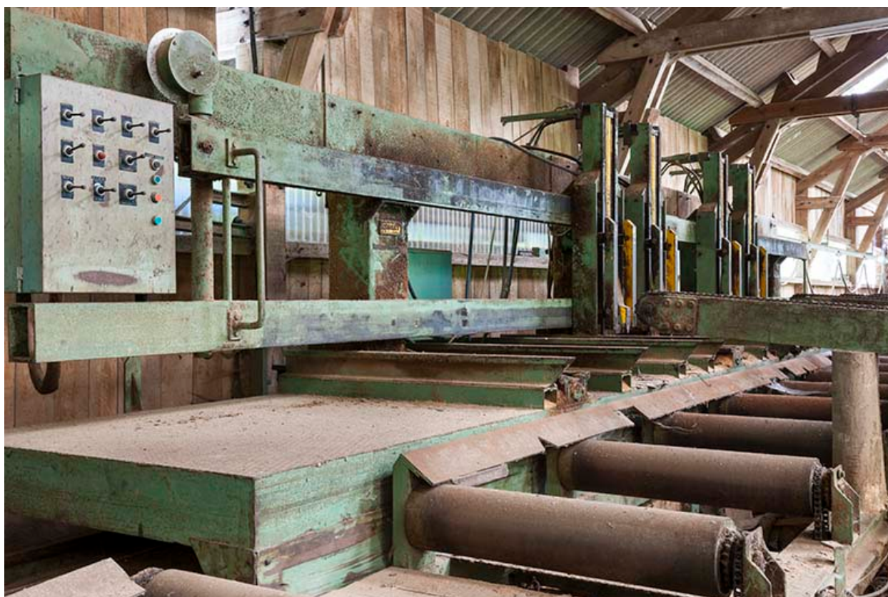
Détail du convoyeur de la scie à ruban.
