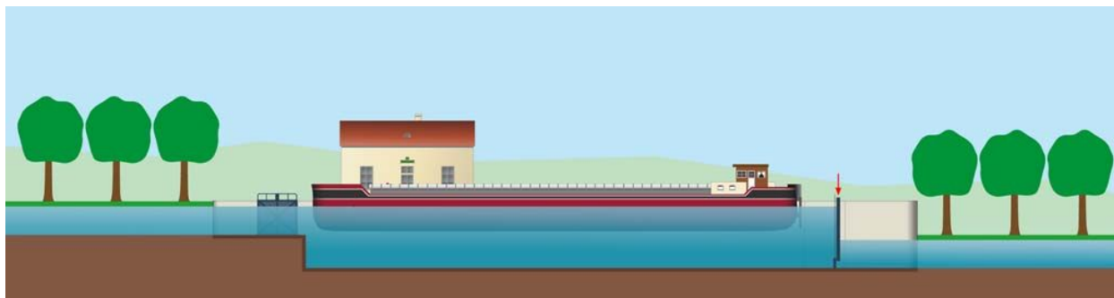
Schéma d'éclusage d'un bateau montant, étape 8.
