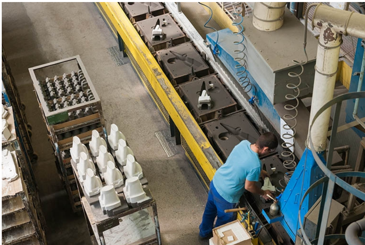
Montage des moules (1).
