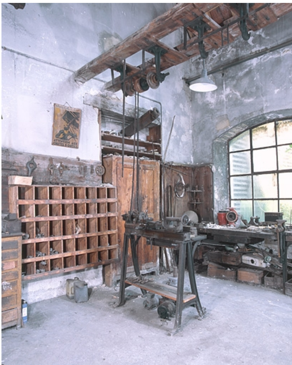
Vue d'ensemble avec son système de transmission.
