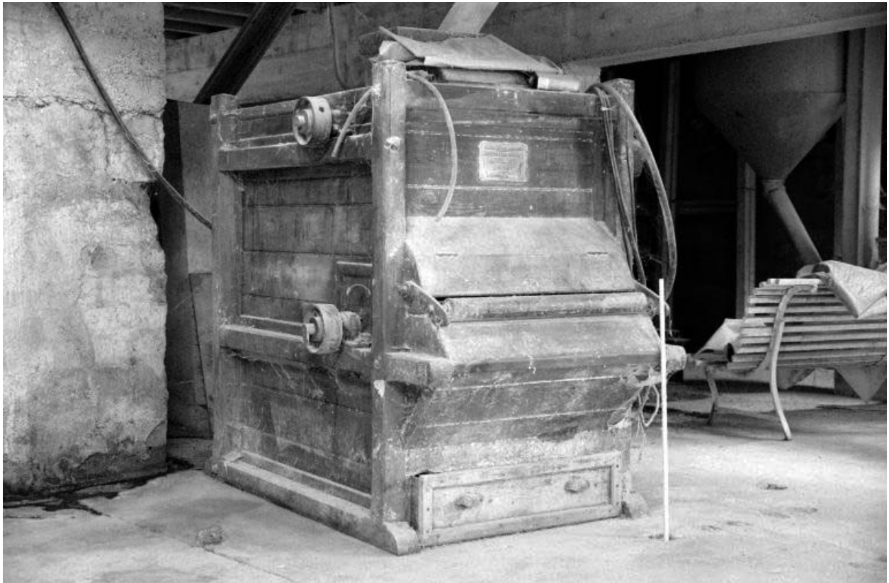
Minoterie (H), étage de soubassement : nettoyeuse à sacs Lhuillier.
