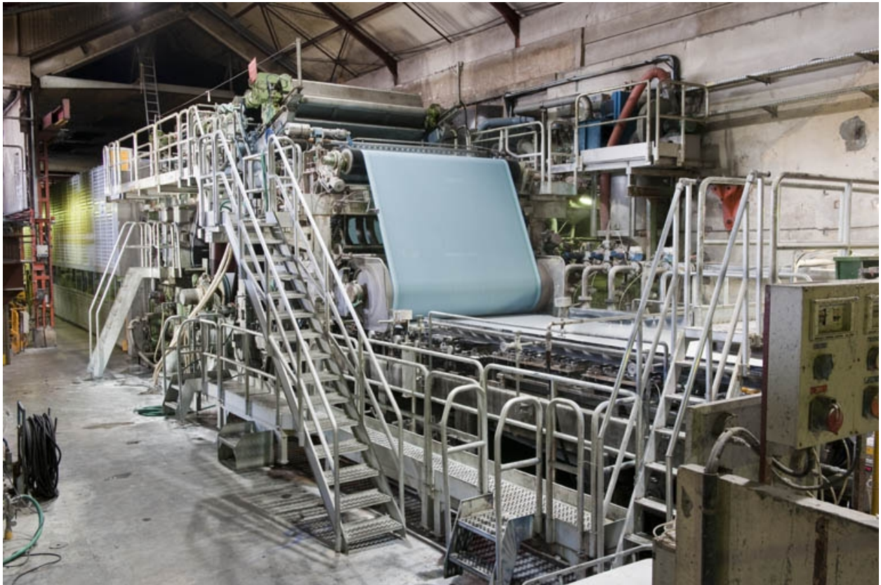
Usine de pâte à papier Paravicini-Maillard, actuellement Papeterie de Mandeur, Mandeur : table de fabrication et tête de la machine à papier.
