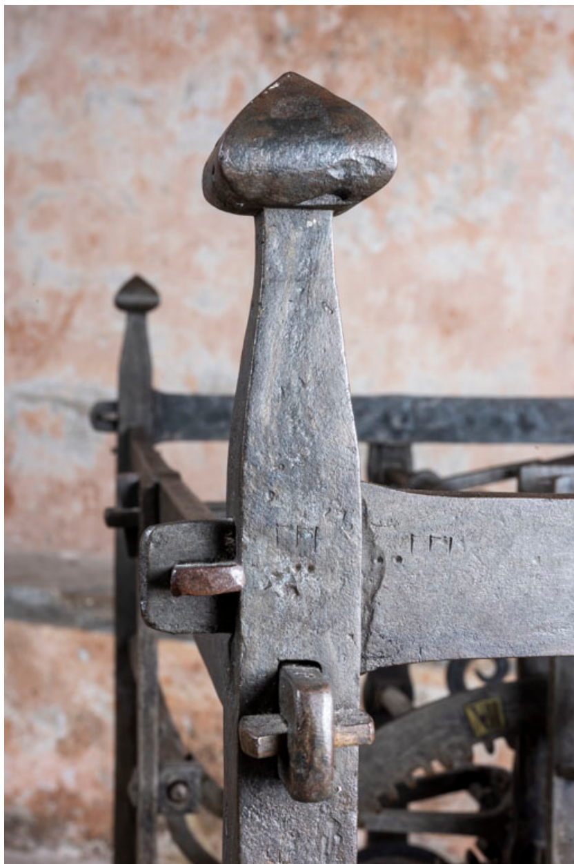
Face latérale droite : système d'assemblage des montants et marques de repérage.
