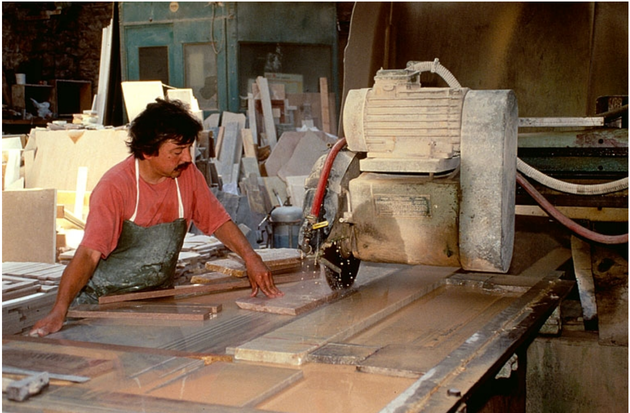
Marbrerie Mourlot puis Yelmini Artaud, Balanod : débitage de plinthes en marbre de Balanod.
