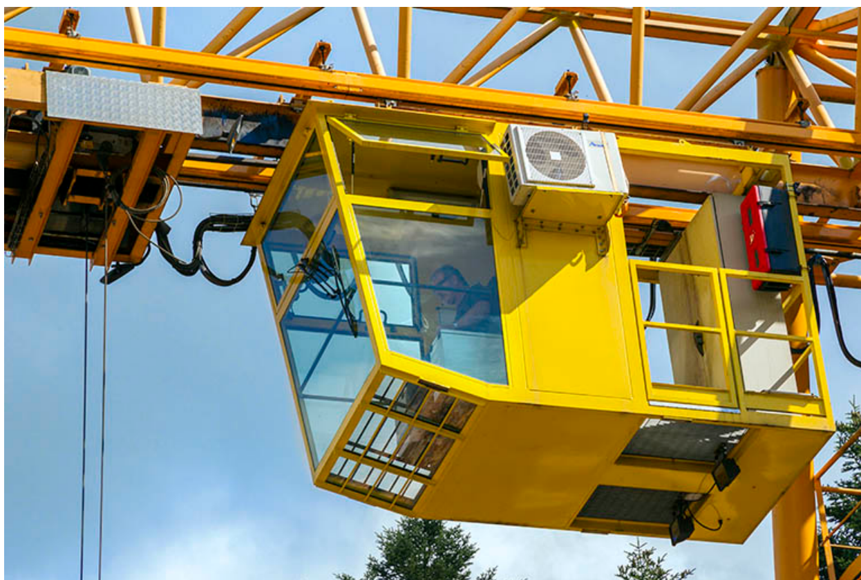
Portique roulant : cabine de commande.
