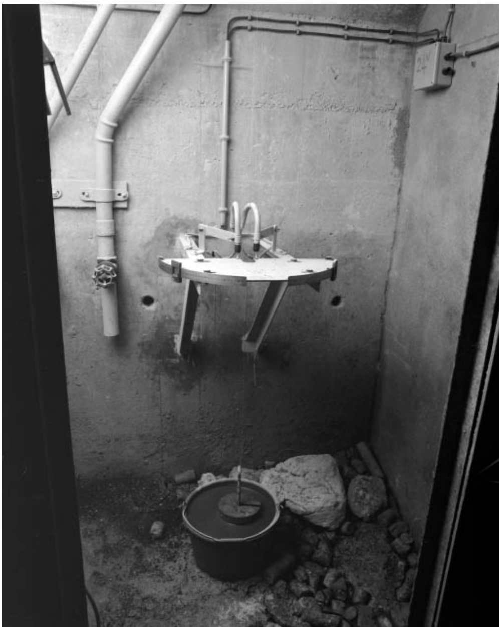
Système d'auscultation du barrage : pendule.
