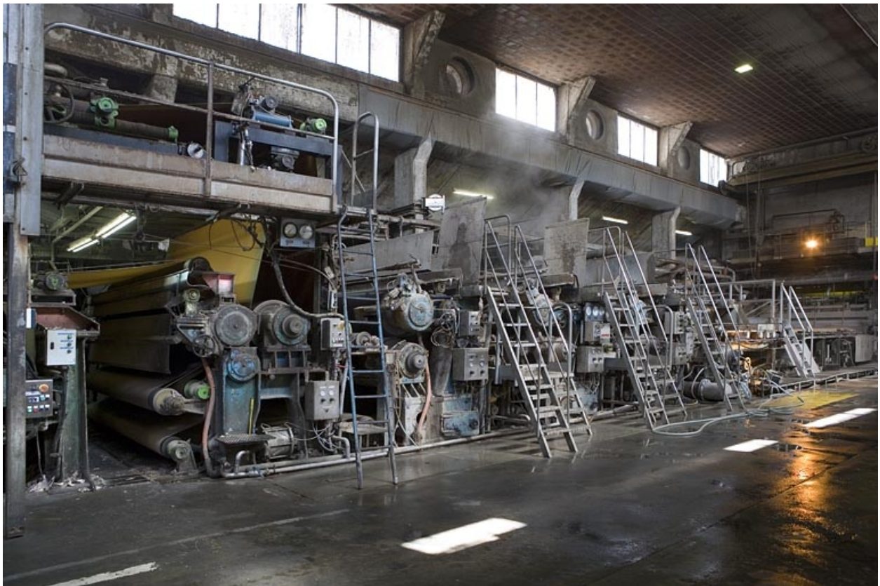
Fabrique de cellulose et usine à papier Jean-Baptiste Weibel et Cie, puis Otor-Papeterie du Doubs, Novillars : presse et cylindres de la machine à papier.
