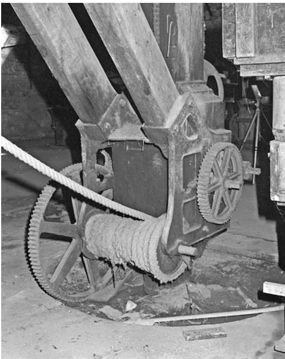
Grue à potence. Détail de la base.
