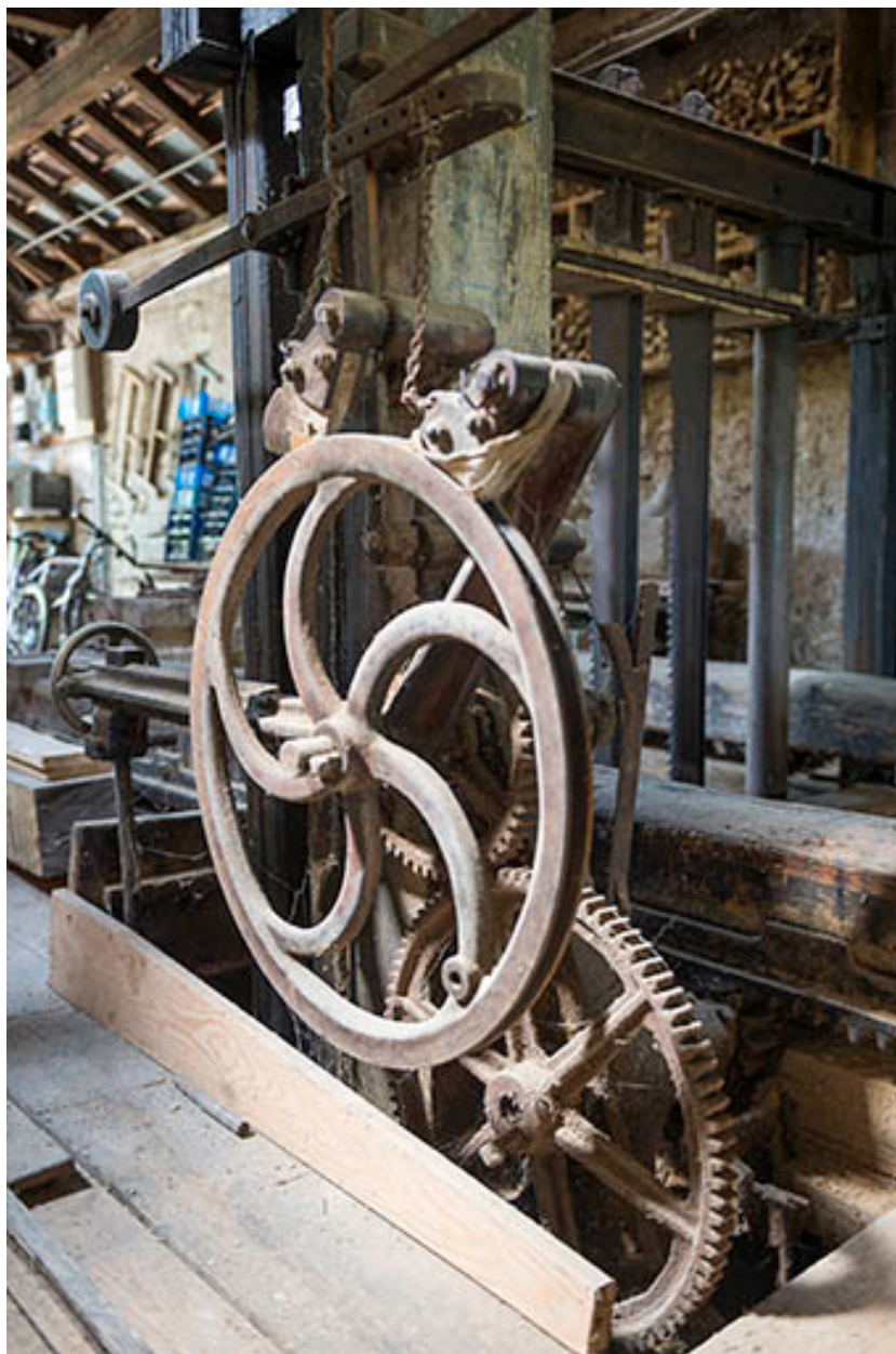
Châssis de scie (ou haut-fer) : volants de transmission du mécanisme.
