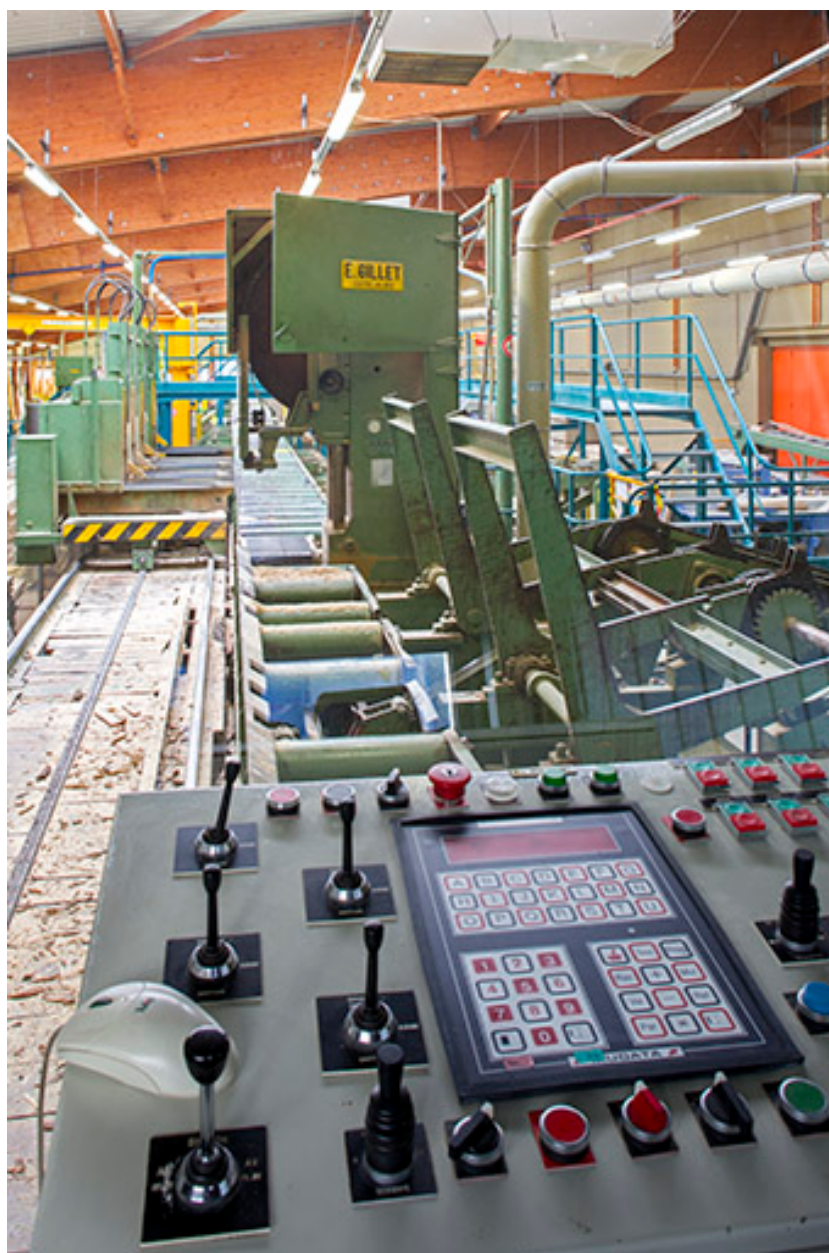
Scierie : machine à commande numérique pour débitage.
