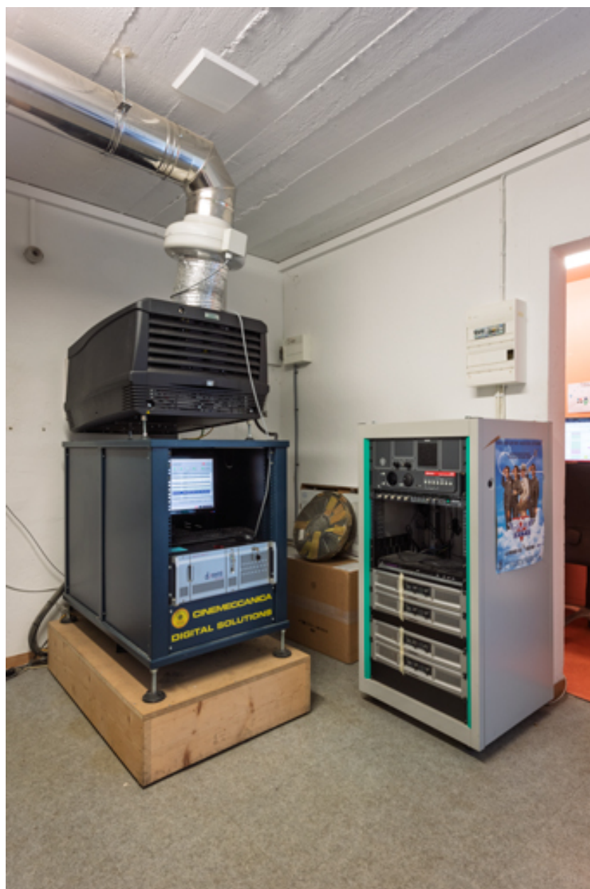
Cabine de projection : projecteur numérique Barco DP2K-15C.
