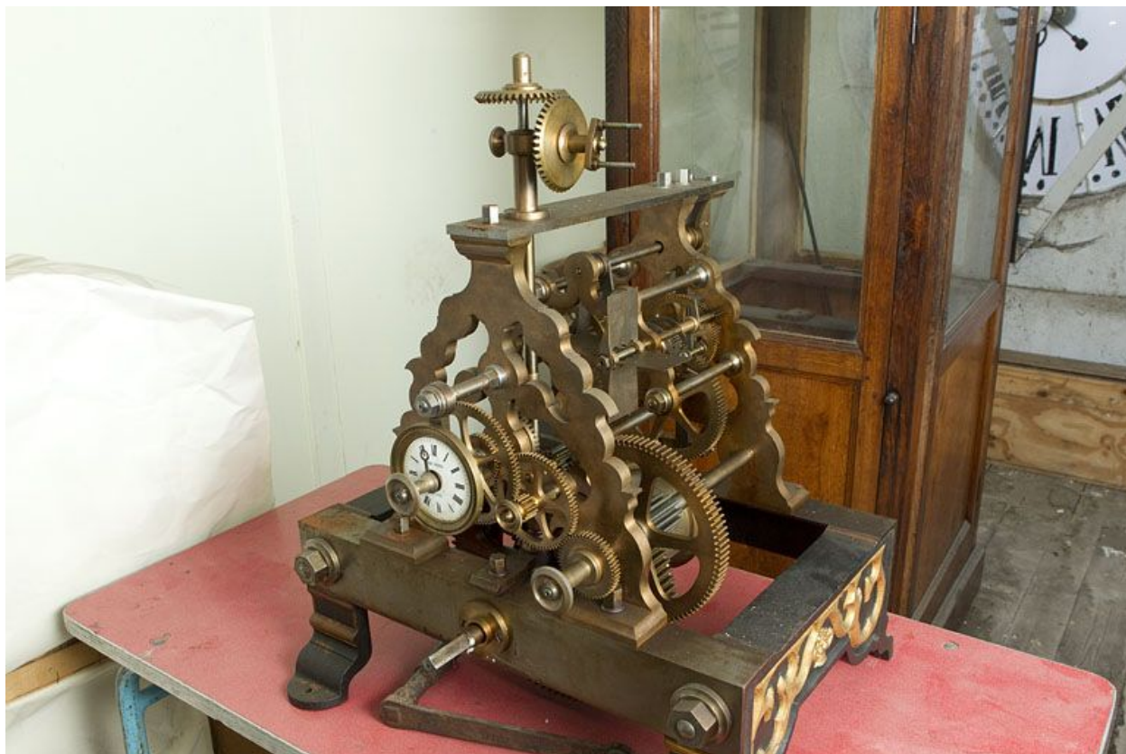
Mouvement (2010) : cadran de contrôle et roues dentées.
