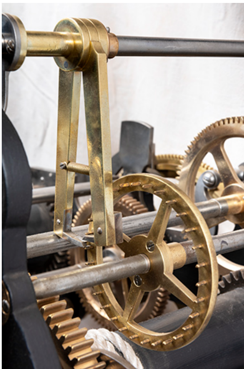
Mouvement, mécanisme des heures : échappement à chevilles.
