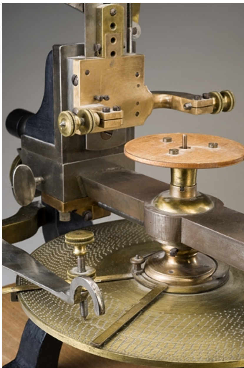
Ensemble porte-outil, plateau de fixation et plateau diviseur.
