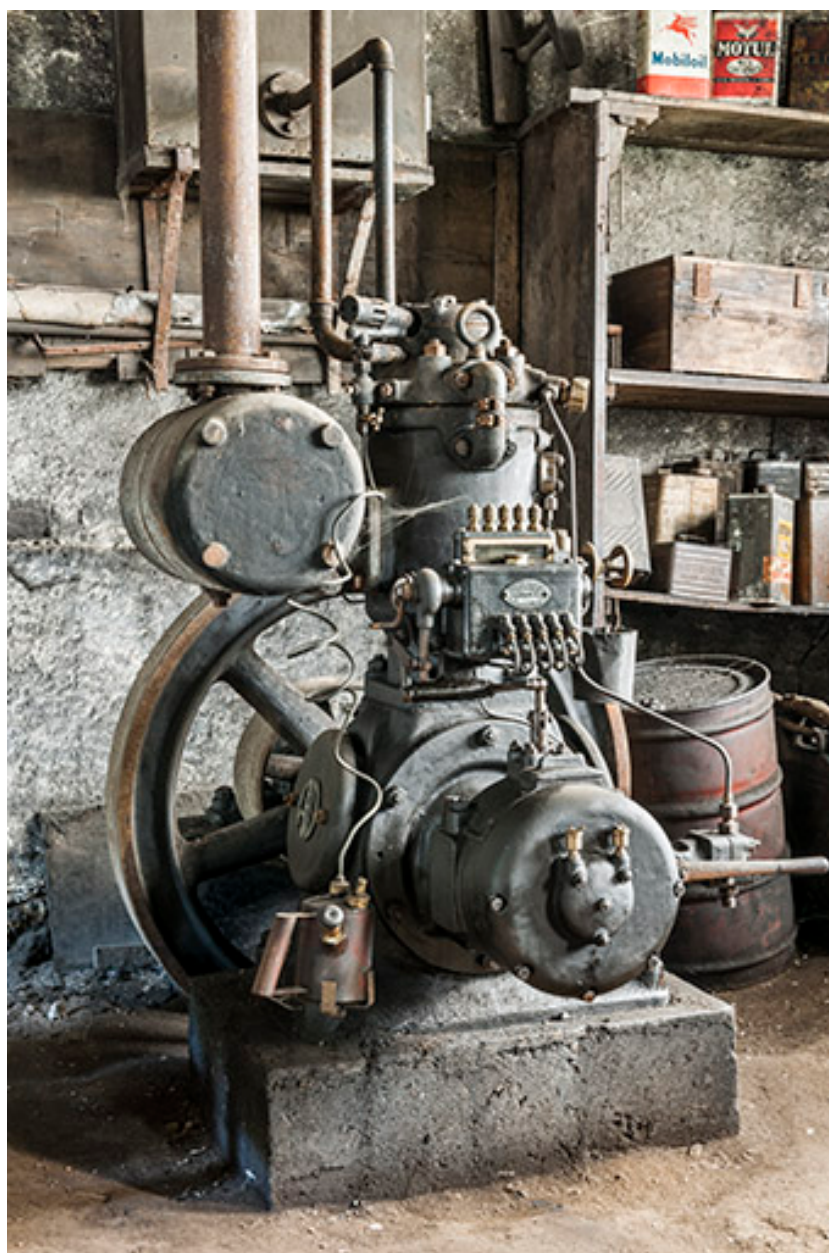
Atelier de mécanique. Moteur semi-diesel Douge.
