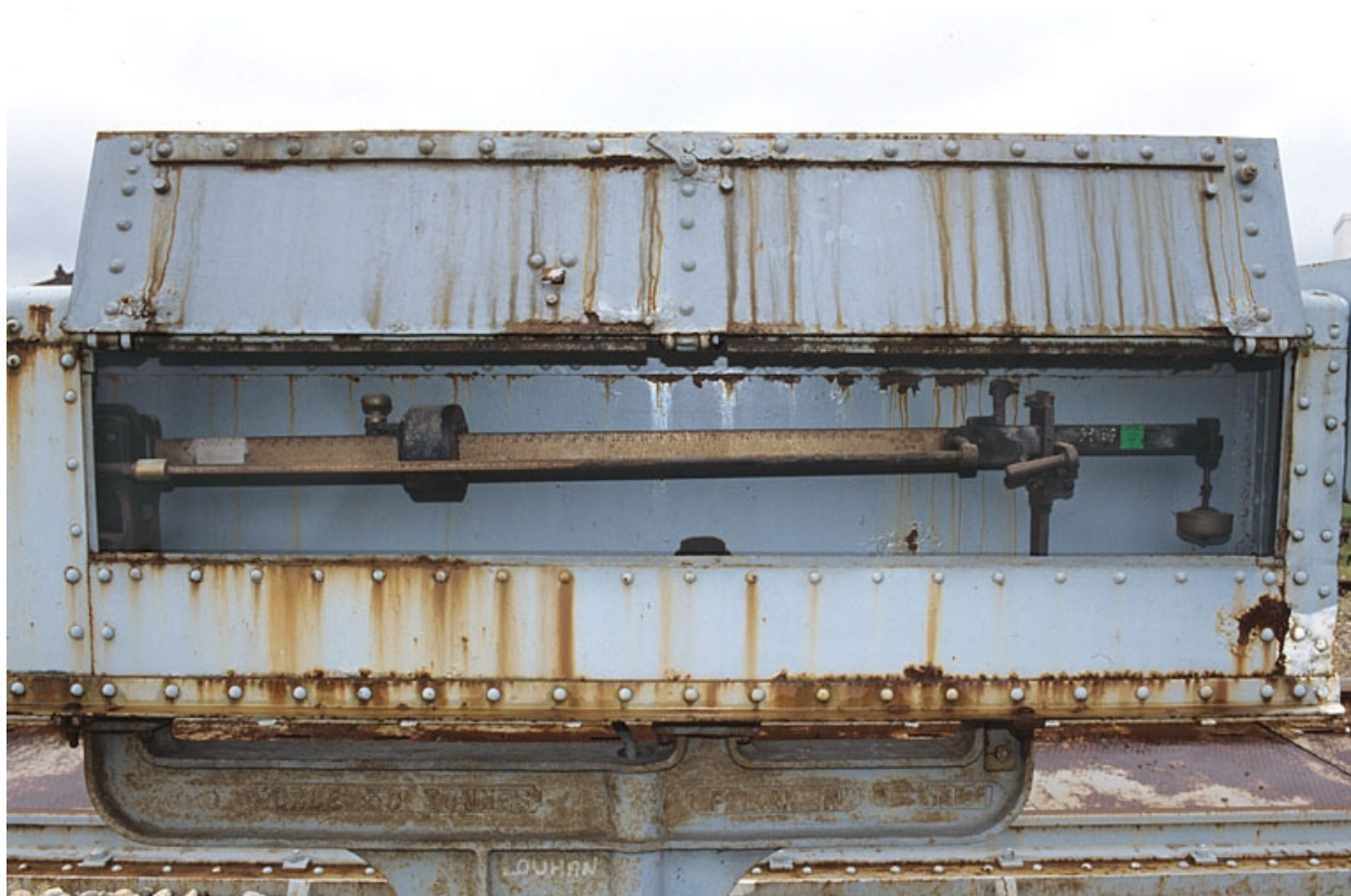
Appareil indicateur, caisse ouverte, montrant le fléau à la romaine.
