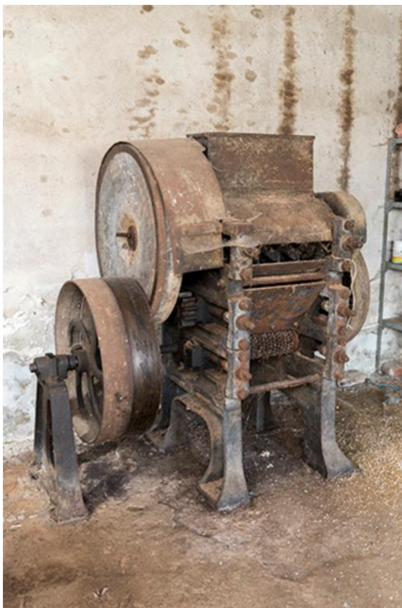
Machine du rez-de-chaussée: broyeur à tourteaux
