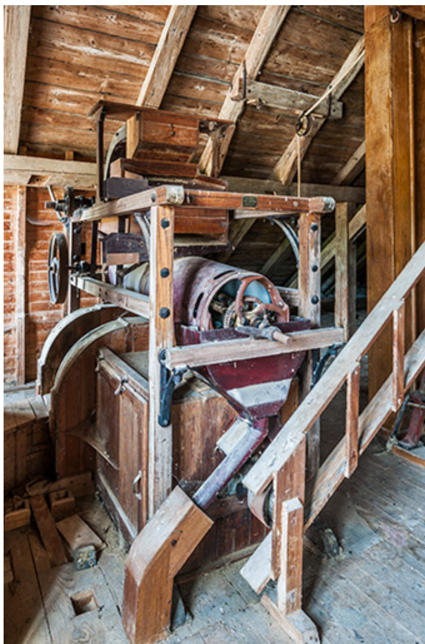
Etage de comble : trieur à grains Lhuillier.
